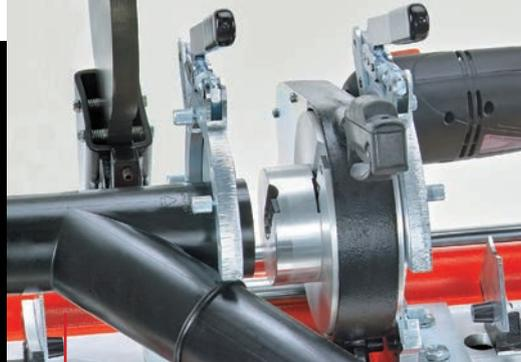
Специально подходит для сварки узких тройников с отводом под 45°.
