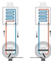
**Принцип работы переключателя струи:** пробить пробку или отложения с 2 сторон для более быстрого и эффективного действия.
